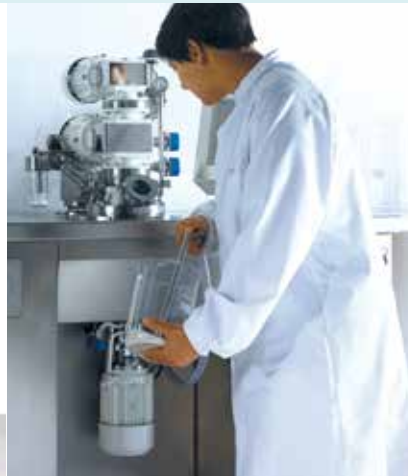
Incorporación de polvos o líquidos bajo vacío en fondo de tanque
